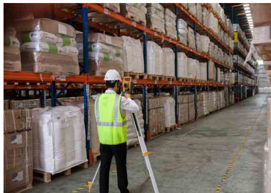
横梁挠度检测
