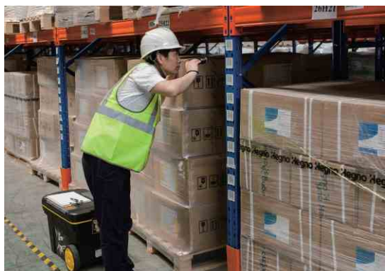
结构件损坏目测
